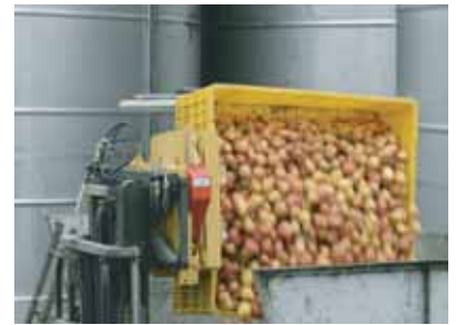
An example of CM dumper. Un esempio di rovesciatore CM.
