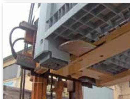
Sopra, un vista di dettaglio delle alette laterali che fuoriescendo dalle forche bloccano i bins
