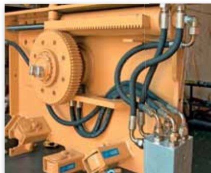
Sopra, un vista di dettaglio delle alette laterali che fuoriescendo dalle forche bloccano i bins
