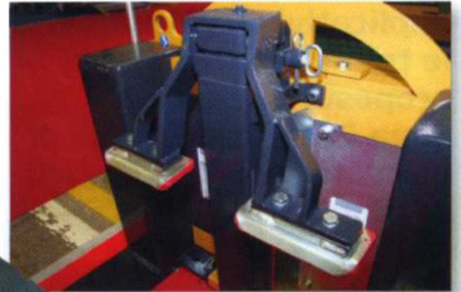
Due immagini di dettaglio del sistema di bloccaggio dei contenitori che assicura una movimentazione sicura e rapida
