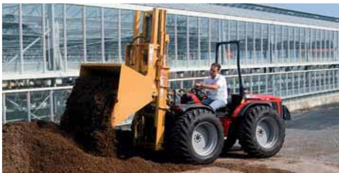
Hanno una capacità di carico che varia da 500 a 4500 Kg, con altezze di sollevamento comprese fra 1600 e 6000 mm.
