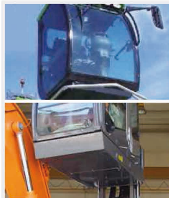
Elevatore per sollevamento cabina.
