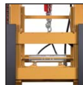
Traslatore laterale FEM FEM side shift
