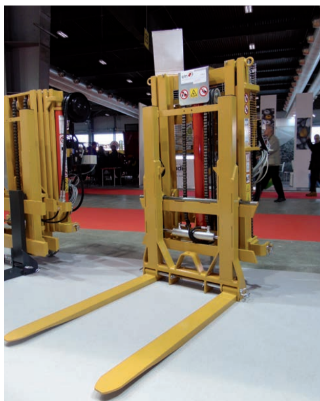
► Nel 2017 l'offerta di CM si è arricchita dell'evoluzione del prodotto CM 16THAD, un elevatore idraulico per i trattori di media potenza, dotato di alzata libera (di 20 cm.) che consente di sollevare il carico senza variare l'ingombro
