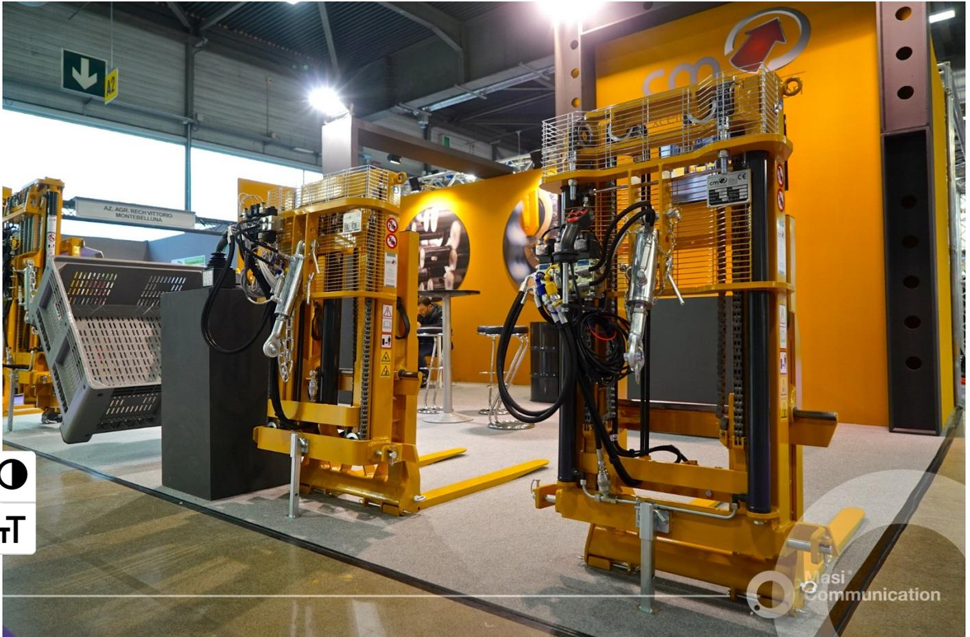
**Gli elevatori**, che vengono applicati ai trattori per la movimentazione e il sollevamento di pedane e bins, necessari per il contenimento dei prodotti agricoli come ortaggi e frutta, sono stati notevolmente apprezzati in fiera. Si tratta di macchine che combinano portate elevate con la leggerezza necessaria a lavorare in modo ottimale, costruite con materiali di alta qualità: profili in acciaio laminato a caldo, cuscinetti ad alta resistenza, catene di sollevamento certificate.
