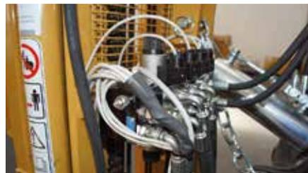
**Il nuovo distributore elettroidraulico proporzionale sviluppato da Cm permette di gestire in modo efficiente e sicuro tutte le attività di movimentazione. Disponibile per l'intera gamma di elevatori della Casa romagnola, ottimizza l'assorbimento idraulico in funzione del carico**
