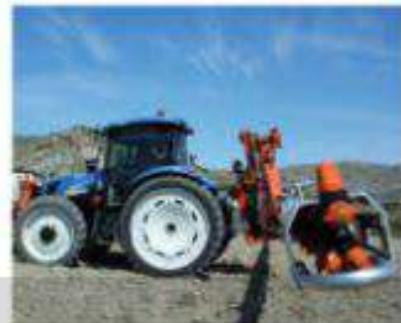
Soluzione combinata per l'irrorazione con serbatoio frontale e barra posteriore. Questa soluzione importata in Italia da Battini Agri si distingue per il perfetto bilanciamento e una struttura che assicura leggerezza e alta manovrabilità anche in condizioni sfidanti: una combinazione vincente caratterizzata da grande versatilità
