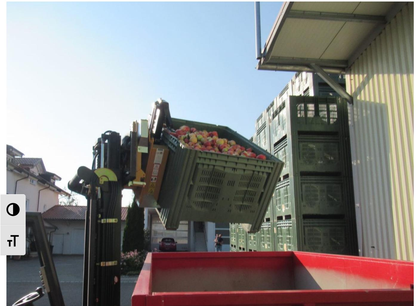
**CM** progetta e costruisce un'ampia gamma di attrezzature per la movimentazione agricola e industriale. Uno dei prodotti più innovativi è il **rovesciatore idraulico** applicabile a tutti i tipi di carrelli elevatori e sollevatori telescopici.
