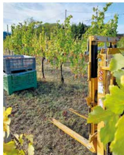
bro verticale rispetto alla posizione di riposo e quindi senza il rischio di danneggiare le colture, mentre al mantenimento costante della velocità di salita e discesa delle forche stesse è preposto un cilindro di sollevamento a doppio effetto che rende di fatto l'intero processo di movimentazione avulso dal rischio di "strappi".
