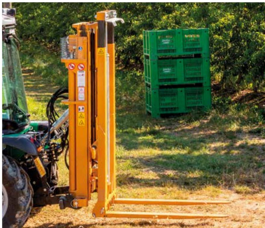
**Forte di una portata di 16 quintali e di altezze massime raggiungibili fino a cinque metri e 20 centimetri, l'elevatore idraulico a tre sfilii di media portata "16 Tbch" di Cm guarda alle necessità delle aziende frutticole di medie e grandi dimensioni che intendono minimizzare le tempistiche legate alla logistica dei raccolti**
