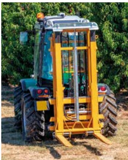
le. Quest'ultimo, nel caso degli elevatori di media capacità Cm, si atesta a 16 quintali e trova la sua più recente applicazione nel modello a tre sfilii "16 Tbch", caratterizzato da un'impronta strutturale incentrata su due cilindri laterali, in luogo del classico cilindro singolo centrale, che comandano l'alzata e la discesa, soluzione che di fatto libera quello spazio visivo che per gli operatori si traduce in un miglior controllo dell'attività in corso.
